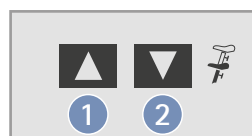
Figuur 6-4: Aanpassen van het zadel op het bedieningspaneel
