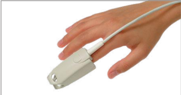
Figuur 5 – 10: Aanbrengen van de standaard SpO2-sensor (voorbeeld)
