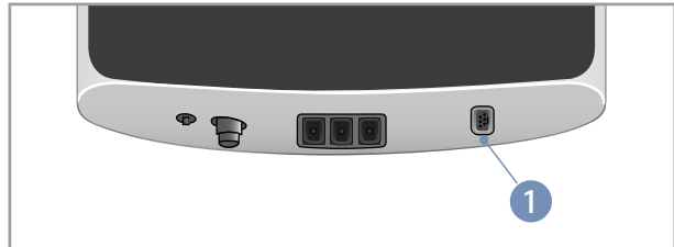
Figuur 4 – 15: Zuurstoftoevoer aansluiten 1 op de SpO2-poort
