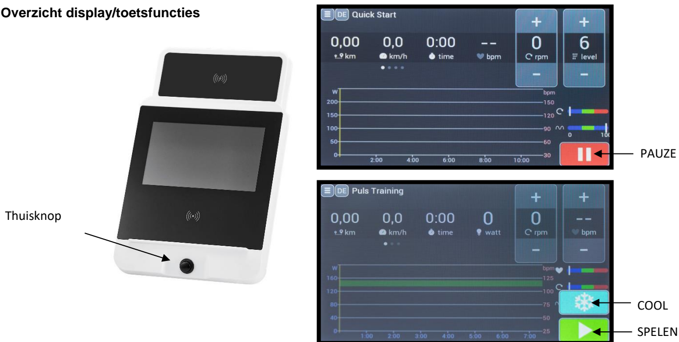
Fig. 9: Monitorbeeld, met uitleg over de knopfuncties, de werkelijke weergave kan in kleur variëren, de toewijzing van de knoppen is hetzelfde.
