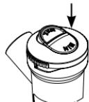
Per rendere più efficace la terapia inalatoria, premete con il dito sull'iscrizione MIN del selettore di velocità (C1.4). In questa posizione, il selettore di velocità agisce come una valvola e permette di nebulizzare la quantità ottimale di farmaco fino alle basse vie respiratorie, riducendone la dispersione nell'ambiente.
