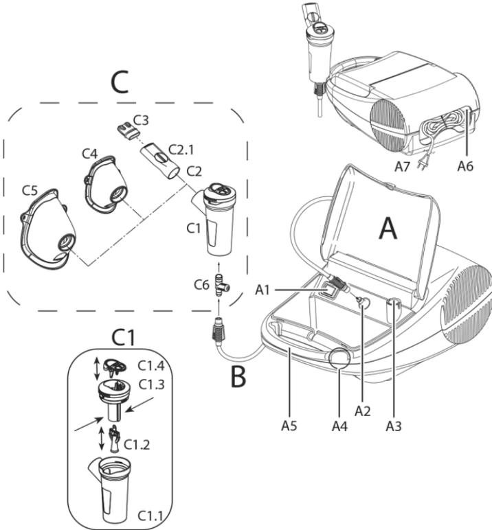
Schema di collegamento - Assembly diagram - Anschlusschema - Schéma de montage - Verbindungsschema - Croquis de conexiones - σχεδιάγραμμα συνδεσμολογίας - لتوصيل مخطط
